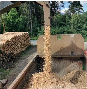
Holzhackschnitzel werden im Wald gehäckselt und direkt zur Heizanlage transportiert.
