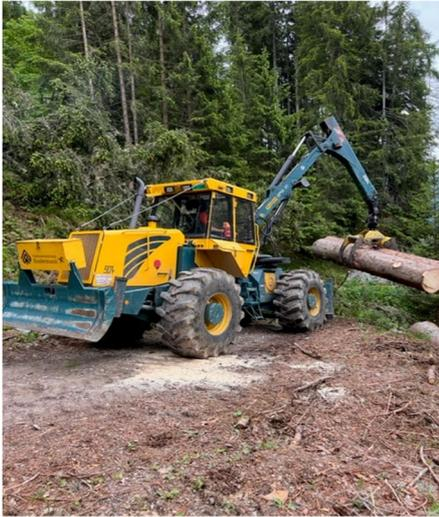
Mit diesem Forst-Spezialschlepper konnten die Baumstämme direkt an die Strasse gezogen werden und für den weiteren Abtransport auf dem Holzlagerplatz gerüstet werden.
