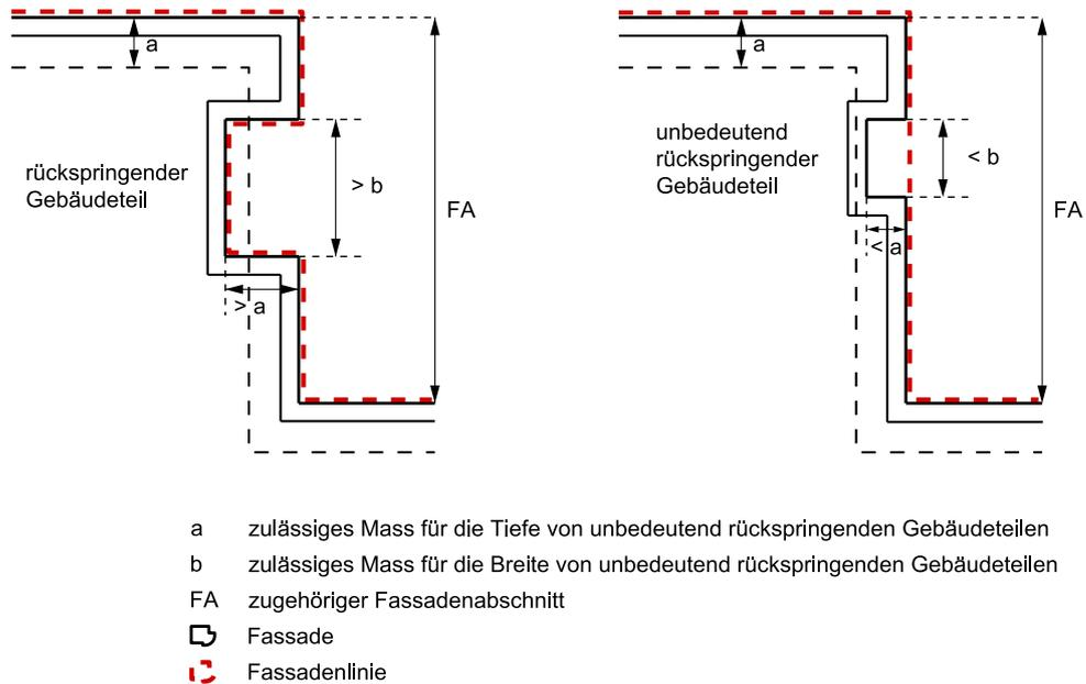
Figur 3.5 Rückspringende und unbedeutend rückspringende Gebäudeteile
