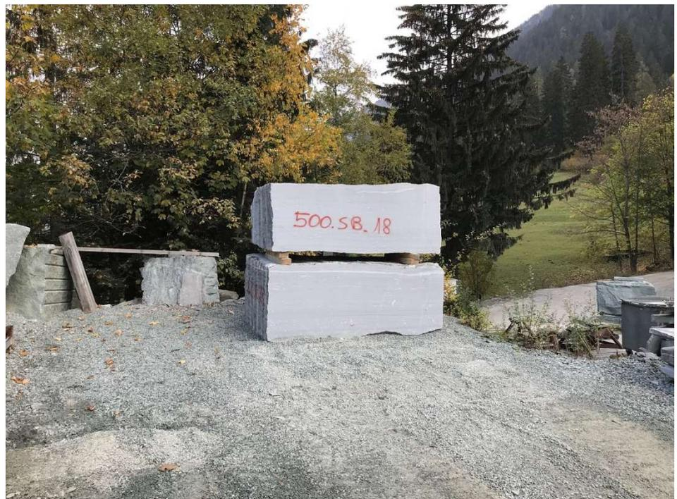
Abb. 13/ Rohblock mit Seilschnitt ermöglicht Qualitätskontrolle vor Abtransport
