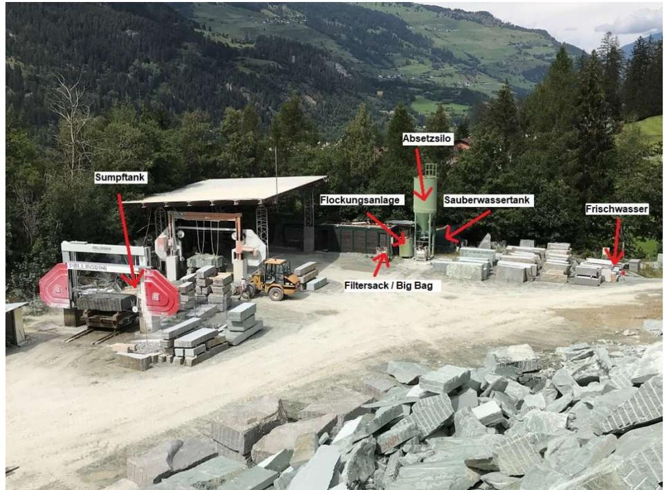
Abb. 15/Übersicht der Wasserreinigung mit Absetzsilos, Sauberwassertank und Filtersäcke
