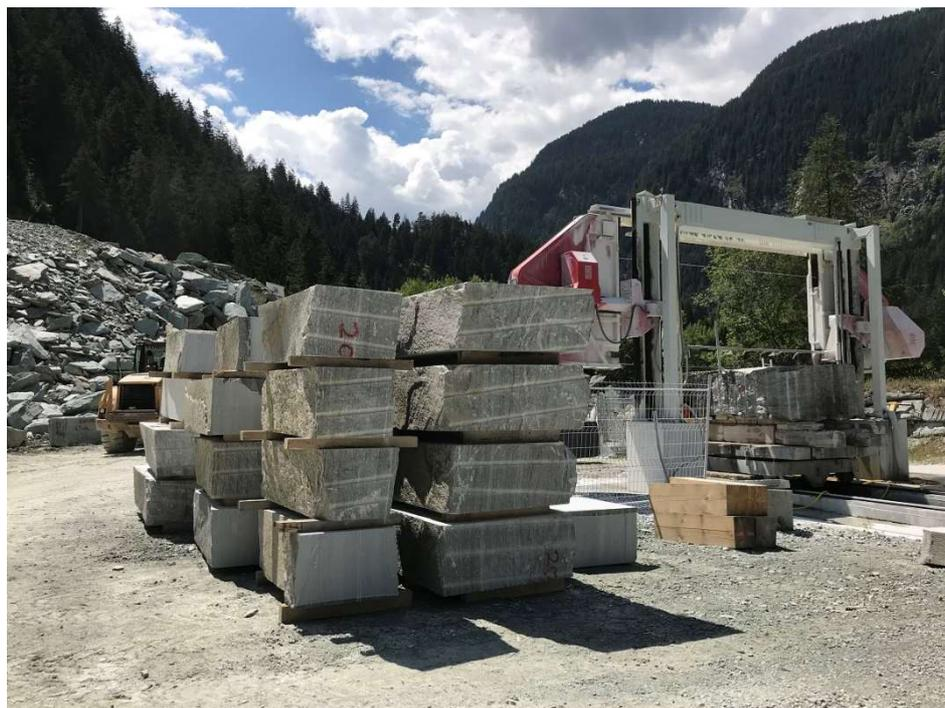
Abb. 14/Kleine Boretten - Ermöglicht massive Erhöhung der Materialausnutzung
